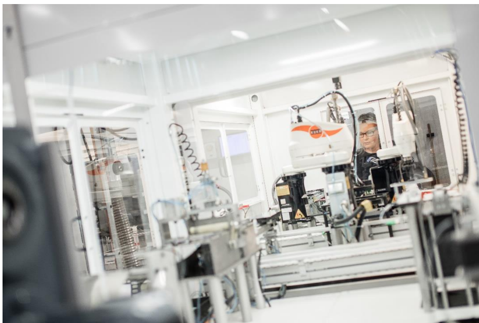
Fullt automatiserad tillverkningsprocess med robotar från KUKA.
