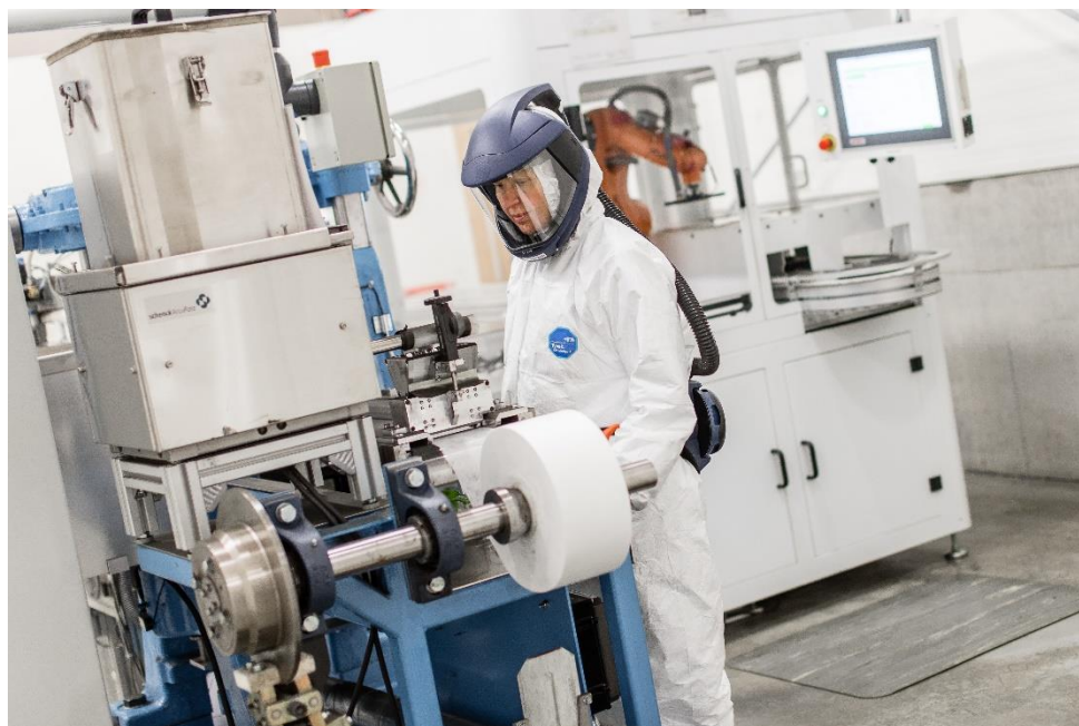
Nilars elektrodproduktion är energisnål och kräver inte något värmesteg.
